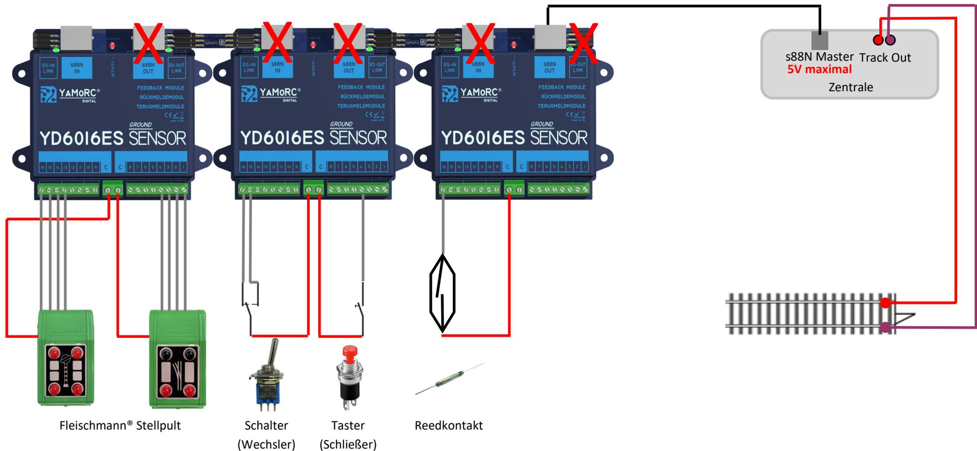
**Maximalausbau:** 96 Rückmelder, bestehend aus fünf Rückmeldemodule mit je 16 Eingängen im gesamten "ES-Link" Strang.
