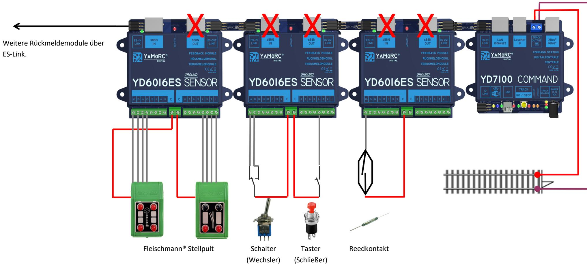
**Maximalausbau:** 96 Rückmelder, bestehend aus fünf Rückmeldemodule mit je 16 Eingängen im gesamten "ES-Link" Strang.
